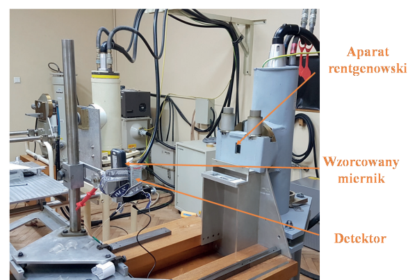
Rys. 3. Układ pomiarowy z aparatem rentgenowskim YXLON MG 325/45
