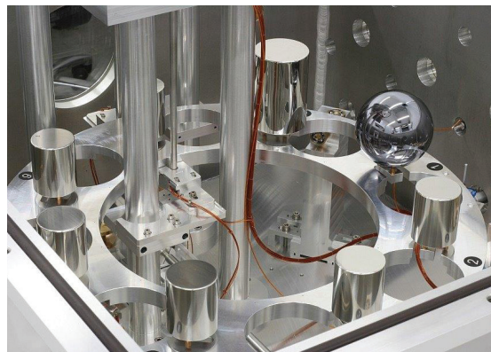
Rys. 8. Komora ważenia wraz z okrągłym stolikiem pomiarowym – tzw. handler – w komparatorze CCL1007 źródło: http://www.ptb.de .
