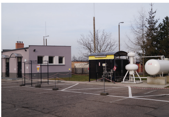
Fot. 2 Stanowisko do badania i wzorcowania liczników kontrolnych instalacji pomiarowych do gazu ciekłego propan-butan (LPG) w Obwodowym Urzędzie Miar w Lesznie
