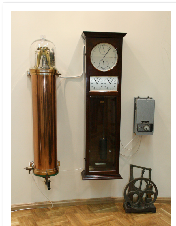
Obecnie działający zegar Shortta w Olsztyńskim Planetarium i Obserwatorium Astronomicznym. Po lewej stronie: zegar główny, pośrodku: zegar pomocniczy z układem tarcz i wskazówek, po prawej: źródło zasilania zegara i pozostałości po ręcznej pompie próżniowej
