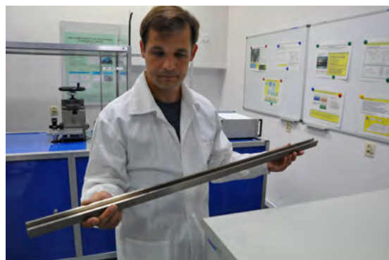
Państwowy wzorzec jednostki miary długości 1 m, stosowany w GUM w latach 1927–1944
