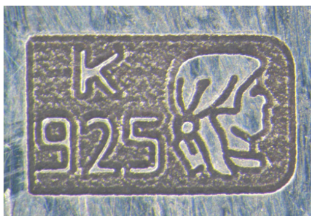
Rys. 10. Cecha plastyczna po polerowaniu i usunięciu wierzchniej warstwy materiału
