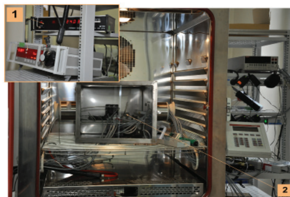
Wzorzec odniesienia wilgotności względnej i temperatury powietrza 1 – pomiary temperatury, 2 – komora klimatyczna
