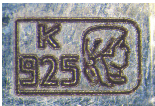
Rys. 7. Cecha liniowa po lekkim oczyszczeniu z nagaru
