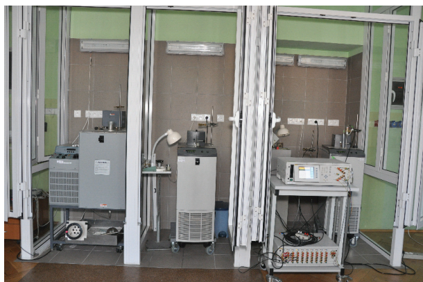
Stanowisko pomiarowe wzorca roboczego jednostki temperatury, realizujące metodę porównawczą w zakresie (-80 \pm 550)\text{ }^{\circ}\text{C}
