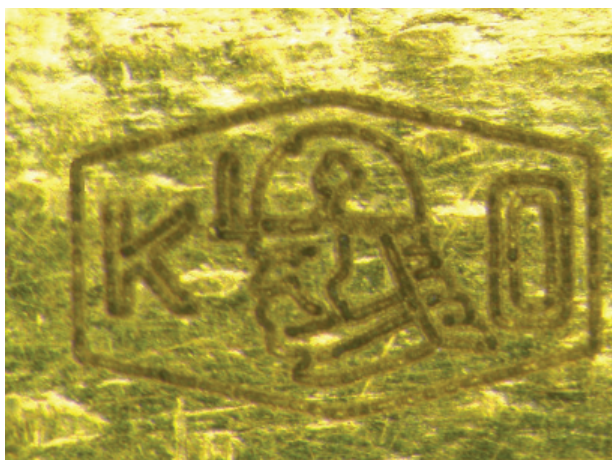
Rys. 5. Wizerunek cechy wykonanej metodą liniową
