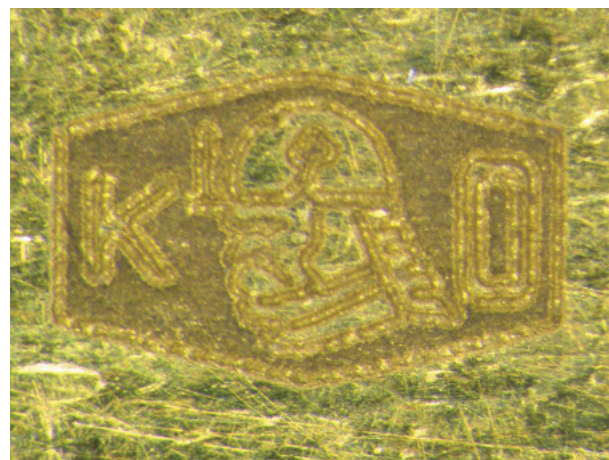
Rys. 6. Wizerunek cechy wykonanej metodą wypełnienia
