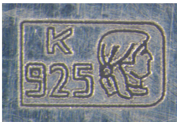
Rys. 8. Cecha liniowa po polerowaniu i usunięciu wierzchniej warstwy materiału
