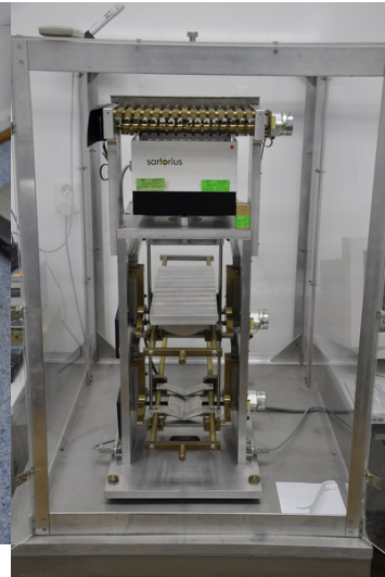
Komparator mas do ważenia butli gazowych - stanowisko do wytwarzania mieszanin gazowych metodą grawimetryczną
