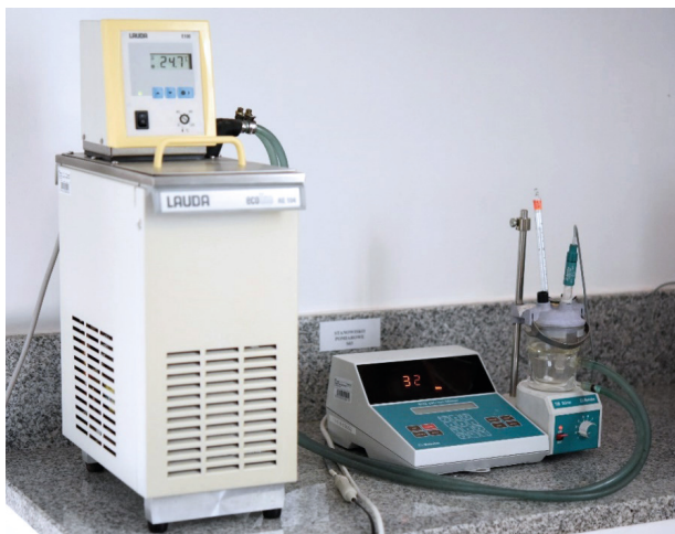
Rys. 1. Stanowisko pomiarowe do wzorcowania wtórnych materiałów odniesienia pH za pomocą ogniwa z elektrodą szklaną w Pracowni Analiz Elektrochemicznych GUM
