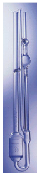
Rys. 2. Wiskozymetr szklany kapilarny typu Ubbelohde
