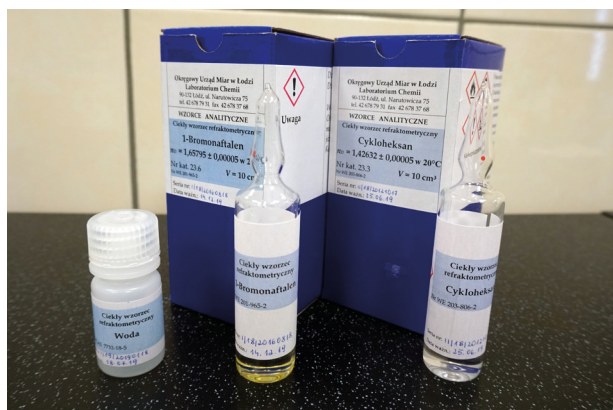
Fot. 18. Ciekłe wzorce refraktometryczne wytwarzane w Okręgowym Urzędzie Miar w Łodzi
