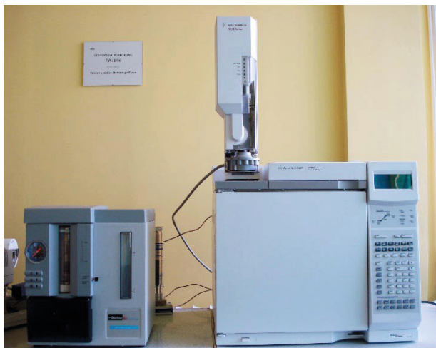
Fot. 6. Stanowisko pomiarowe do chromatografii gazowej
