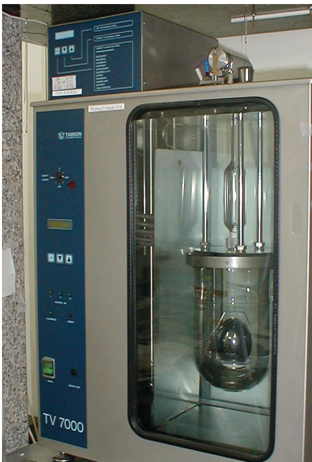
Rys. 6. Wyznaczanie gęstości cieczy na stanowisku ważenia hydrostatycznego
