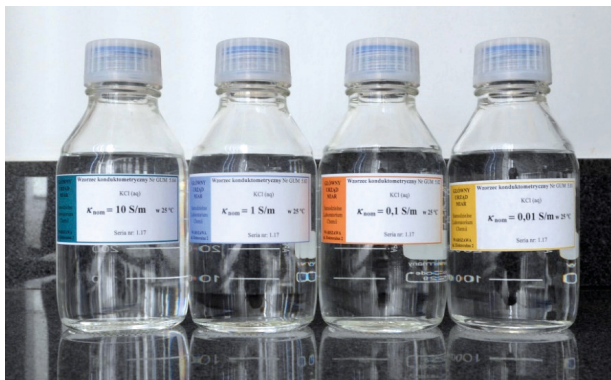
Rys. 2. Pierwotne konduktometryczne certyfikowane materiały odniesienia GUM
