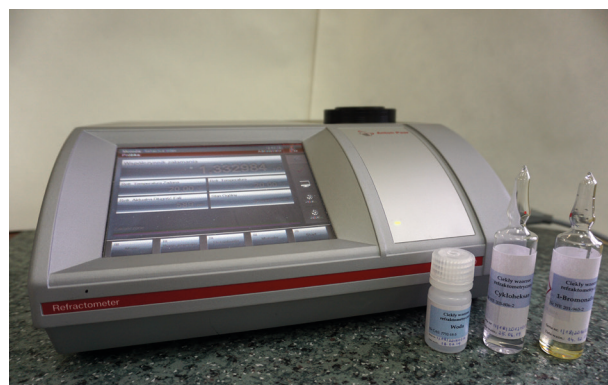
Fot. 17. Stanowisko do pomiaru współczynnika załamania światła
