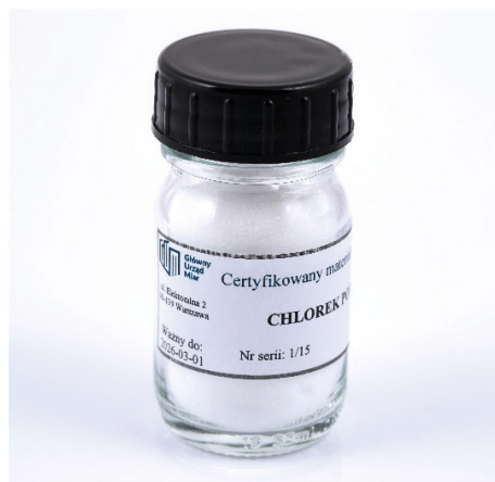
Rys. 4. Pierwotny materiał odniesienia ilości substancji – chlorek potasu
