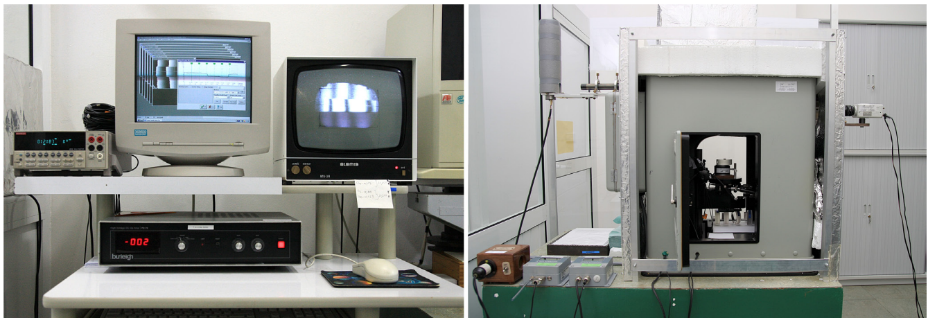
Interferometr z lampą spektralną ^{114}\text{Cd}
