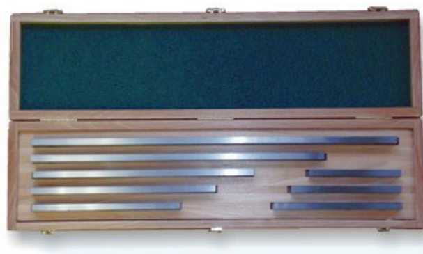
Komplet płytek wzorcowych o długościach nominalnych od 125 mm do 500 mm
