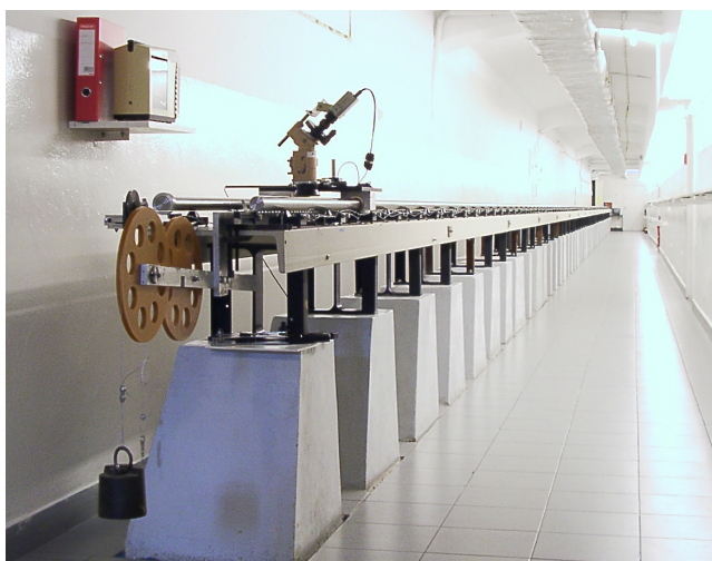
Stanowisko pomiarowe do wzorcowania przyrządów pomiarowych – komparator interferencyjny o zakresie pomiarowym 50 m
