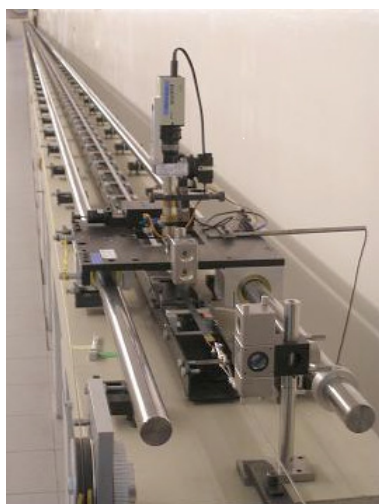
Stanowisko pomiarowe do wzorcowania przyrządów pomiarowych – komparator interferencyjny o zakresie pomiarowym 50 m
