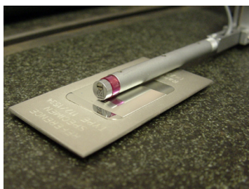
Stanowisko do sprawdzania przyrządów do pomiaru chropowatości – zestaw kontrolnych wzorców chropowatości wraz z płytkami wzorcowymi i interferencyjnymi
