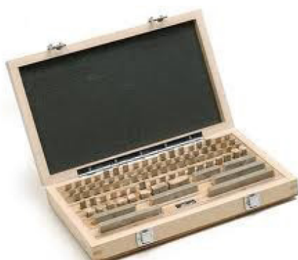
Komplet płytek wzorcowych o długościach nominalnych od 0,5 mm do 100 mm
