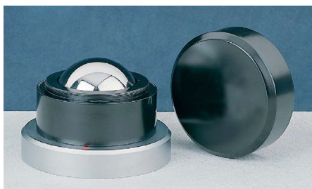
Stanowisko do sprawdzania przyrządów do pomiaru chropowatości – zestaw kontrolnych wzorców chropowatości wraz z płytkami wzorcowymi i interferencyjnymi
