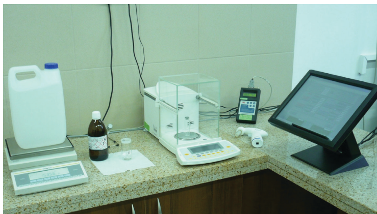
Rys. 2. Stanowisko do sporządzania wzorca ciekłego
