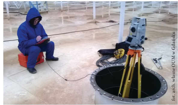
Rys. 8. Wzorcowanie zbiornika z dachem pływającym przy użyciu tachimetru
