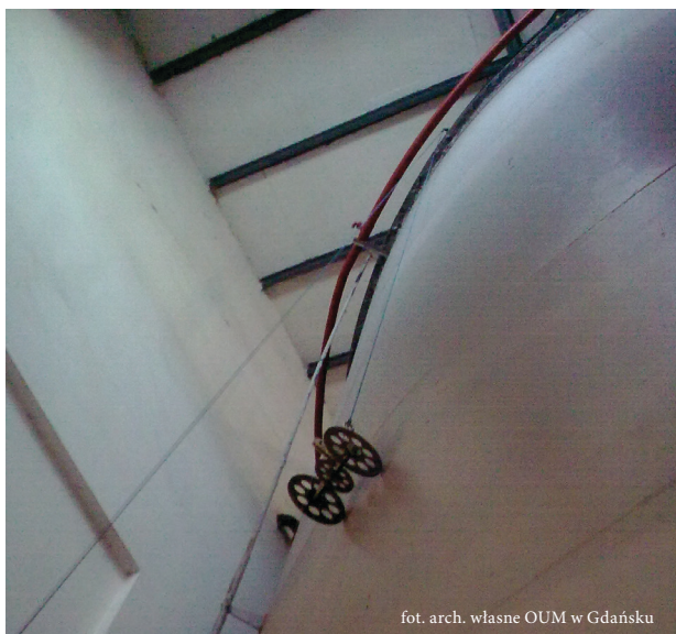
Fot. 2. Wzorcowanie zbiornika metodą geometryczną przy zastosowaniu metody optycznej linii odniesienia za pomocą wózka pionującego
